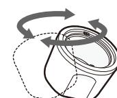
蓄冷容器を斜めにしながら回し、隙間から出てきた水分を完全に拭き取ってください。
