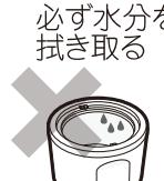
金属部分に残った水滴が凍り、使用時に回転ブレードがひっかかって故障の原因となります。
