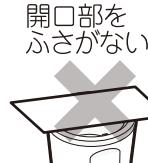
蓄冷容器に冷気が届きにくくなり、内部の保冷剤が凍るまでの時間が長くなります。
