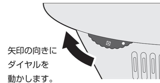
3. 使用後は【電源ダイヤル】を「
